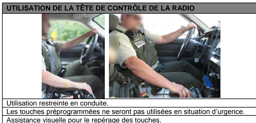
Figure 38 Postures d'utilisation de la tête de contrôle du système de communication radio.
