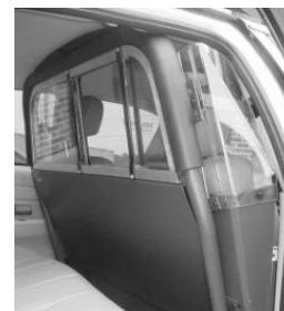
Figure 31 Cloison complète avec fenêtre coulissante. www.fleetsafety.com
