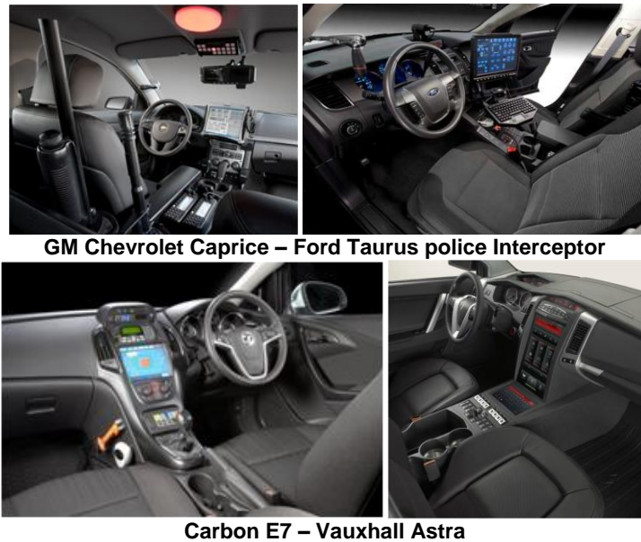
Figure 5 Exemples d'intérieur de véhicules de patrouille présentant des aménagements intégrés au tableau de bord. Dans les véhicules GM et Ford, une réflexion est faite sur l'intégration des outils de travail, toutefois les systèmes informatiques sont superposés aux commandes du tableau de bord. Malgré tout, ce choix permet une versatilité dans le choix du système en question et son utilisation. Dans le cas du Carbon E7 et du Vauxhall Astra, tous les équipements sont intégrés dans le véhicule, y compris le système informatique, ce qui libère l'espace, mais rigidifie le mode d'utilisation du véhicule.
