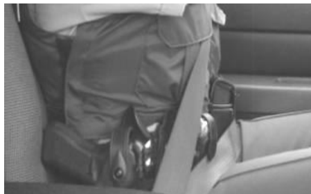
Figure 49 Encombrement de la ceinture de sécurité et des équipements portés.
