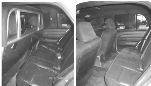
Figure 32 Vue de l'intérieur de l'habitacle arrière d'un Crown Victoria avec et sans cloison.
