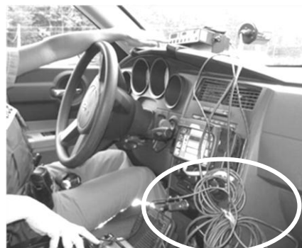
Figure 34 Atteinte à bout de bras du cinémomètre et encombrement des fils de l'antenne et de la manette.
